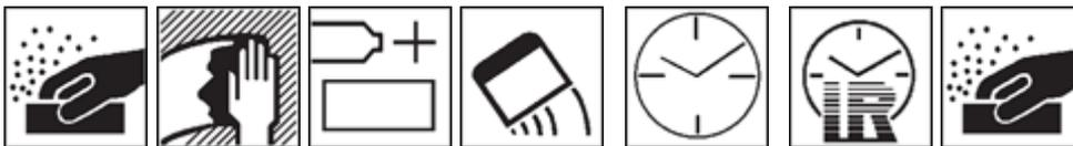
отшлифовать    обезжирить    время нанесения 3-5 мин/20°C    наносить шпателем    20-30 мин/23°C    5-8 мин    P120-P400
